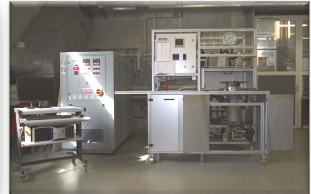
Autoclave scCO 2 , P_{\max} 300 bar, T_{\max} 300 ° C
